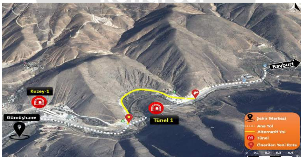
Şekil 10. Tünel 1'de meydana gelebilecek bir aksilik durumunda Bayburt istikameti ve Gümüşhane merkez arasında güvenli bir ulaşımın sağlaması amacıyla önerilen alternatif güzergâh.
