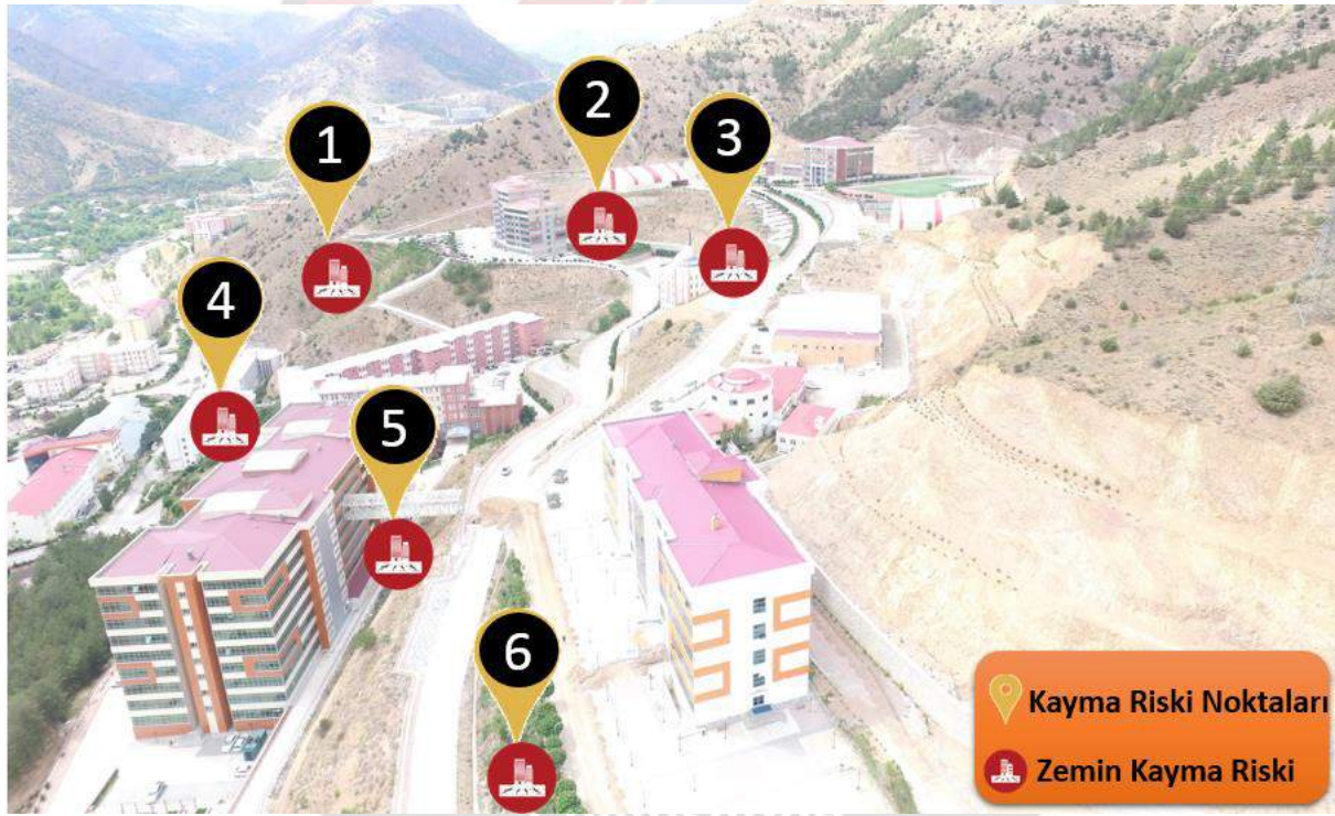
Şekil 9: Merkez yerleşkesinde yağışlar sonrası zeminde kayma meydana gelebilecek riskli bölgeler.
