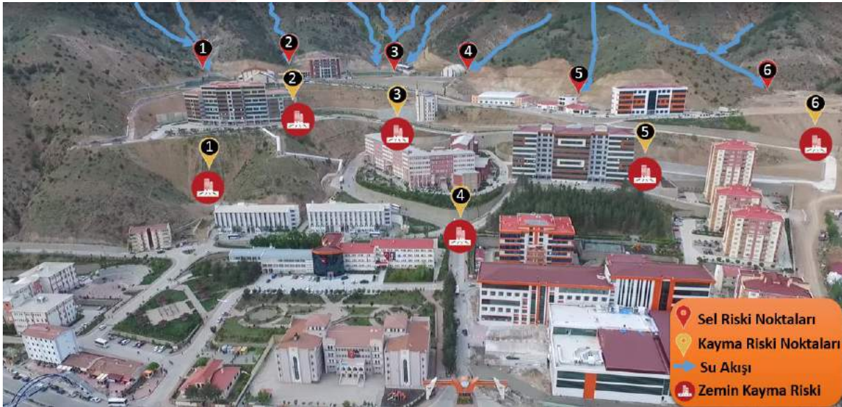
Şekil 6: Gümüşhane Üniversitesi Merkez Yerleşkesi üzerindeki mevcut drenaj problemleri ve zemin kayma riski olan bölgeler.
